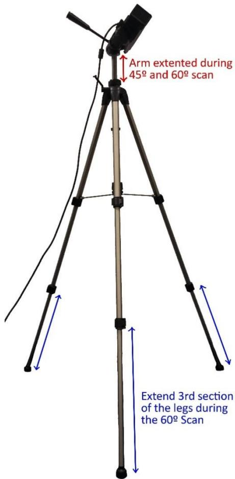
FIGURE 12 – TRIPOD LEGS POSITIONS
