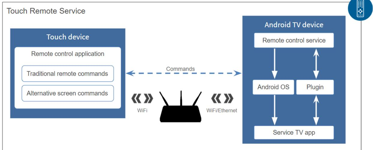
FIGURE 135. TOUCH REMOTE CONTROL ARCHITECTURE
