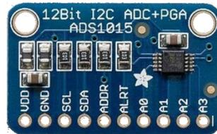
**Figure 53: Adafruit 12bit ADC converter ADS1015 breakout board**
