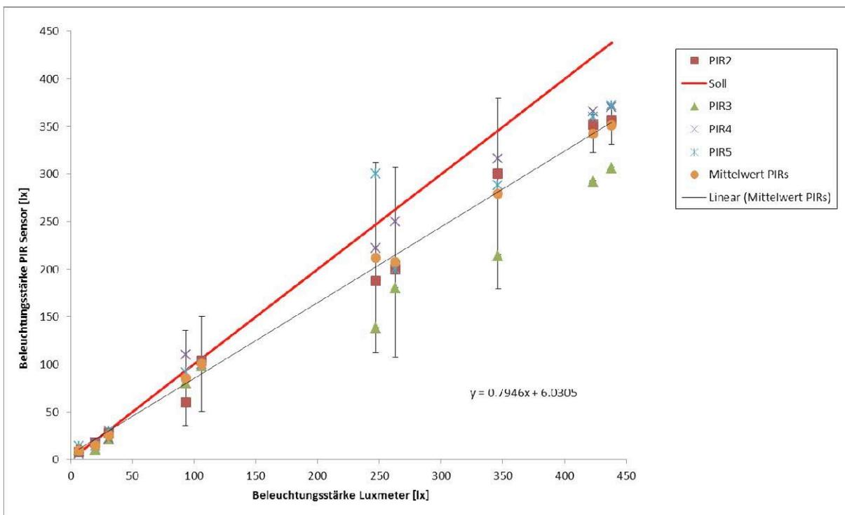
Im Bereich von ca. 70 – 4400 lx ergeben sich große Schwankungen in der Messung der Beleuchtungsstärke, so kann es sein dass der angezeigte Wert der PIR-Sensoren um bis zu  $\pm 1000$  lx schwankt.
