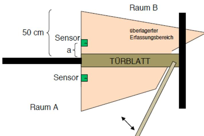
Die Detektionswahrscheinlichkeit liegt bei **100%**, wenn die Tür geöffnet und geschlossen wird. Auch stimmt die Reihenfolge der Detektionen. Zwanzig durchgeführte Türdurchgänge sowohl von Raum A nach Raum B, als auch umgekehrt konnten korrekt detektiert werden.
